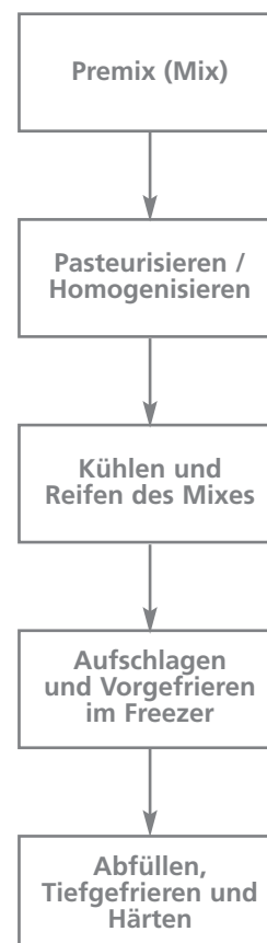
Abb. 1: Verfahren zur industriellen Herstellung von Speiseeis
